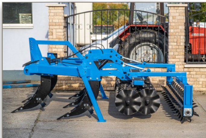
5 késes mélylazító, hullámos tárcsasorral
