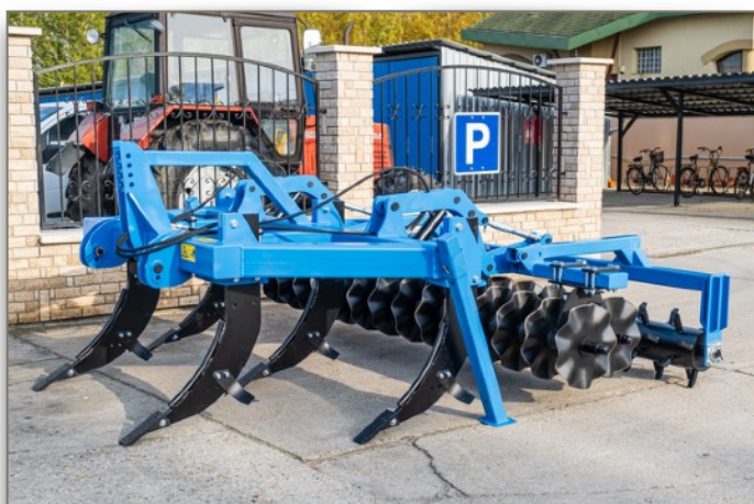
5 késes mélylazító, hullámos tárcsasorral
