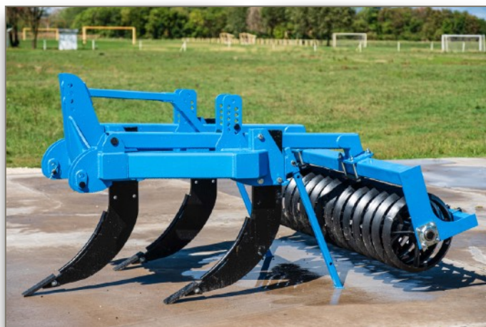
3 késes mélylazító, ékgűrűs hengerrel
