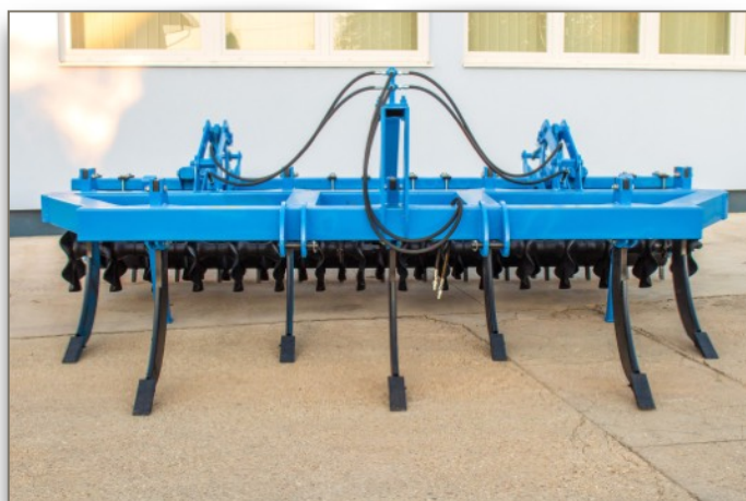
7 késes mélylazító, hullámos tárcsasorral
