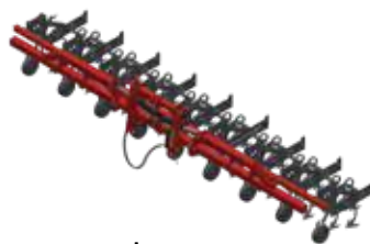
EC-Weeder 8 120 × 120 mm-es négyszögletű keret
