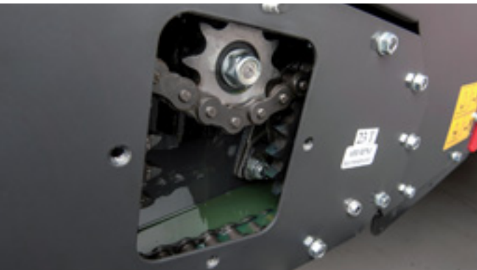
Antriebsselemente mit Ölbadschmierung: unbegrenzte Lebensdauer, die Kette muss nicht mehr ausgewechselt werden.
