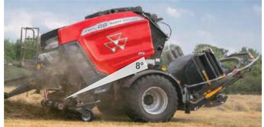
Die neue Protec-Kombination weist einen flacheren Winkel des Gutflusses auf, was zu einer niedrigeren Gesamthöhe der Presse führt. Dies steigert die Fahrstabilität und ermöglicht somit einen sichereren und schnelleren Einsatz an Hängen. Darüber hinaus wird auch der Gegendruck im Zuführungsbereich reduziert, was den Materialfluss optimiert und das Risiko einer Blockade minimiert.
