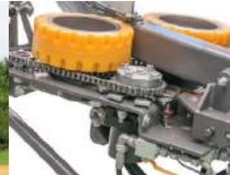
Der Wickelring wird von zwei großen Gummirollen angetrieben. Das sorgt für eine große Kontaktfläche, Vermeidung von Schlupf und ein äußerst geringes Geräuschniveau.
