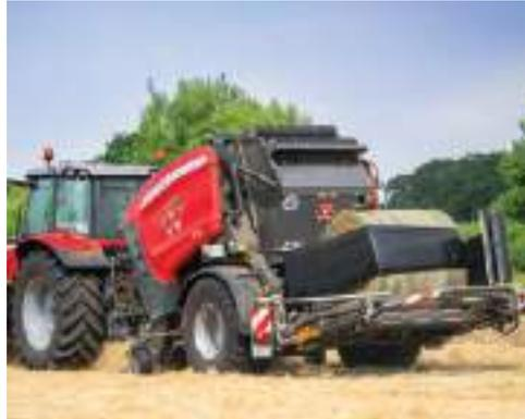
Sobald der Ballen in die Mitte des Wickeltisches befördert wurde, beginnt ein hydraulisch angetriebener Wickelring zu rotieren, bevor die Heckklappe vollständig geschlossen ist. So ist der Zyklus abgeschlossen lange bevor der nächste Ballen zum Wickeln bereit steht. Der robuste Rahmen ist auf extreme Lasten ausgelegt und das Getriebe läuft stabil und sanft – und das Ballen für Ballen.
