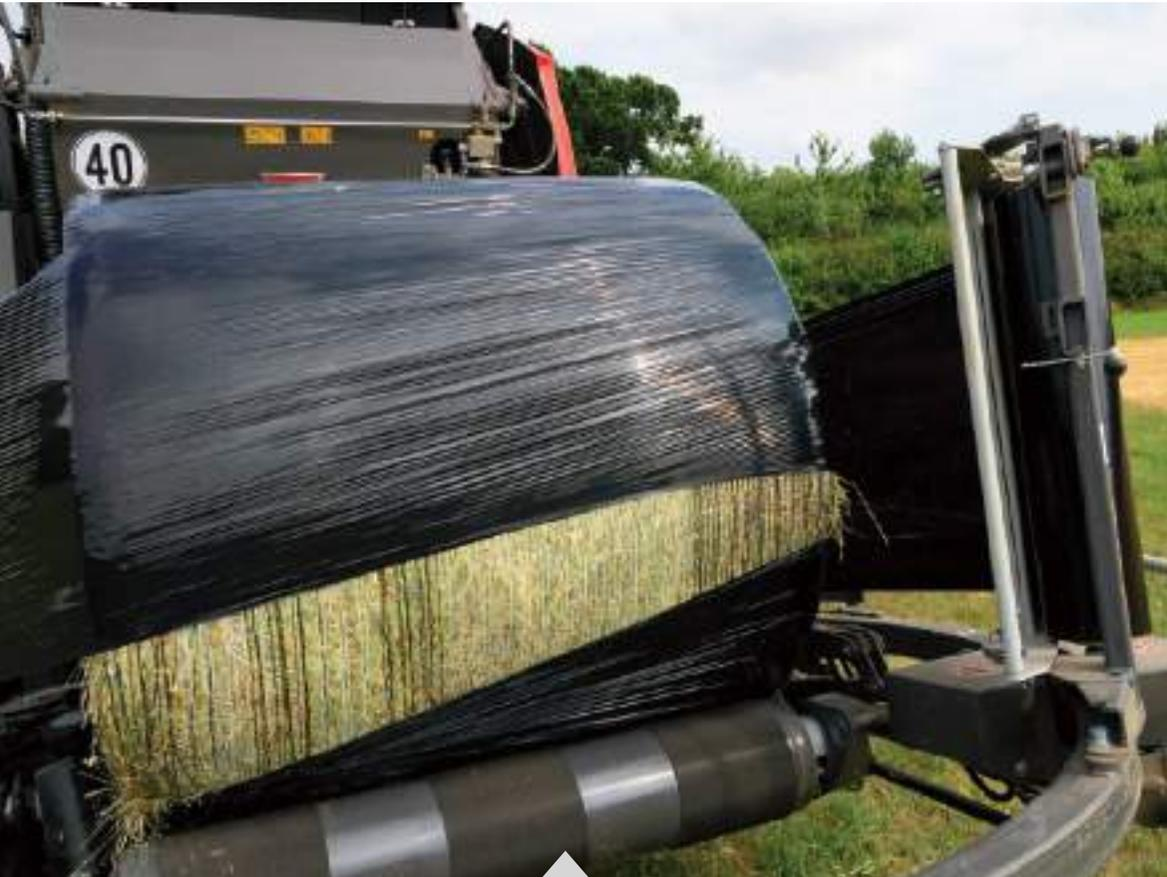
Der hydraulisch betriebene Wickeltisch besteht aus zwei Rollen und drei Endlosriemen auf einem geschweißten Rahmen, was eine noch bessere Langlebigkeit bedeutet. Ein Sensor unterhalb des mittleren Riemens stellt sicher, dass der Wickelvorgang erst beginnt, wenn der Ballen korrekt auf dem Tisch platziert wurde, während vier lange seitliche Stützrollen den Ballen beim Wickeln in der Mitte halten.
