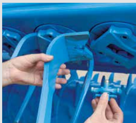
A fogak cseréje a gyorscsereős rendszer segítségével
