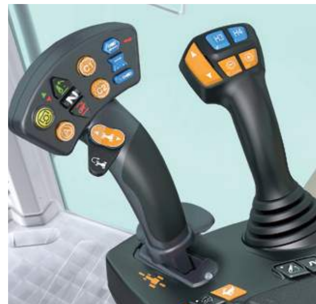
Exclusive fülkeopció Multipad vezérlőkarral és elektronikus többfunkciós botkormánnyal (jobb oldal)
