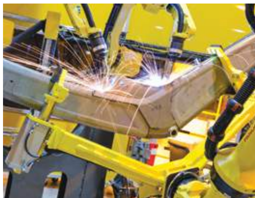
Robotizált hegesztés biztosítja a pontosságot és a szilárdságot
