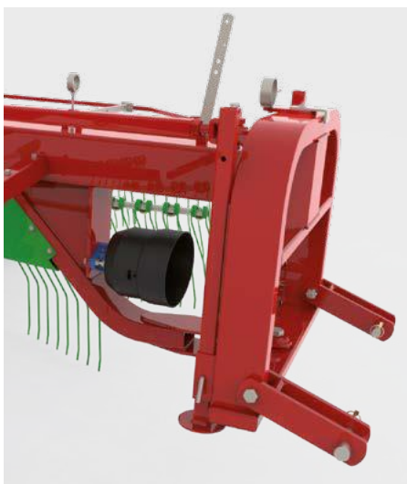
Semi-trailed pivoting hitch. Attelage pivotant semi-entraîné.
