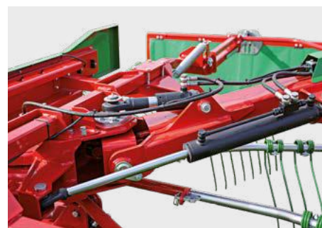
Rear pivoting joint and hydraulic cylinder for working width adjustment Articulation pivotante arrière et vérin hydraulique pour le réglage de la largeur de travail.
