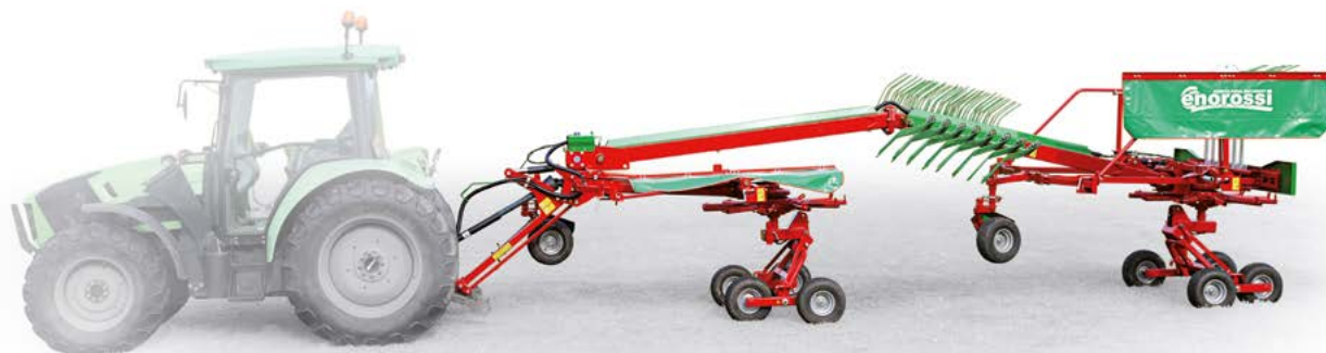
Tracer 780 in transport configuration with disassembled raking arms. Tracer 780 dans la configuration de transport avec bras démontés.
