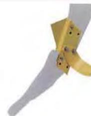
**Esplosori ad alette**, le alette laterali regolabili permettono una maggiore esplosione e ribaltamento del terreno in superficie.
