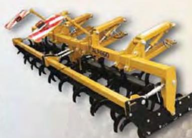
Franter H-40 **pieghevole** con regolazione di **profondità IDRAULICA**, per modelli KX ( $\varnothing$  195mm)
