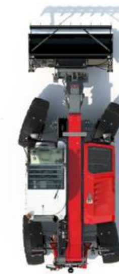
FÉL-OLDALAZÓ KORMÁNYZÁSI mód a hátsó kerekek kikormányzási szöge állítható. Szilázskezelésnél vagy istállótakarításnál hasznos üzemmód.
