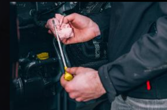
A mellső híd és a „karcsúsított” motorháztető kialakításának köszönhetően az olajsínt-ellenőrző nívópálca és a szűrő is könnyen hozzáférhető.
