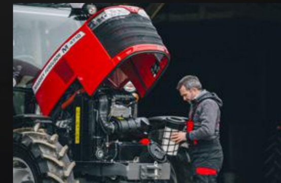
A motor légszűrője könnyen hozzáférhető és tisztítható.
