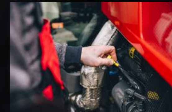
A mellső híd és a „karcúsított” motorháztető kialakításának köszönhetően az olajsínt-ellenőrző nívópálca és a szűrő is könnyen hozzáférhető.
