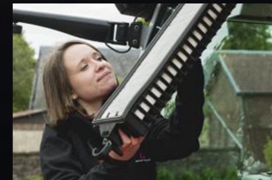
A fülke légszűrője könnyen hozzáférhető a tisztítás céljából történő kiszéréshez.
