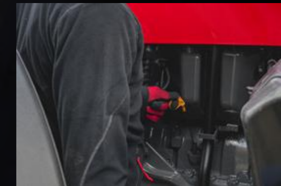
A mellső híd és a „karcsúsított” motorháztető kialakításának köszönhetően az olajsínt-ellenőrző nívópálcá és a szűrő is könnyen hozzáférhető.
