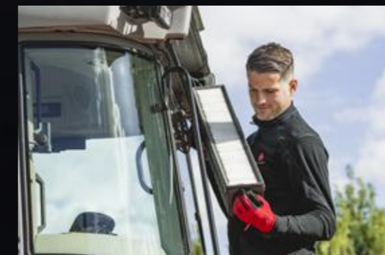
A fülke légszűrője könnyen hozzáférhető a tisztítás céljából történő kiszereleshez.
