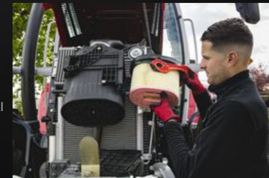
A motor légszűrője könnyen hozzáférhető és tisztítható.
