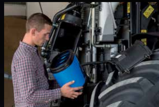
A jól arányosított hűtőegység könnyen hozzáférhető tisztítás és karbantartás céljából. A hűtőventilátor által keltett szívóhatásnak köszönhetően a por 90%-a természetes úton távozik. A motor légszűrője szintén nagyon könnyen hozzáférhető és tisztítható.
