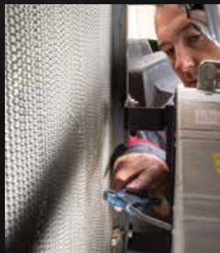
A hűtőradiátorok tisztításához bőséges hely áll rendelkezésre.
