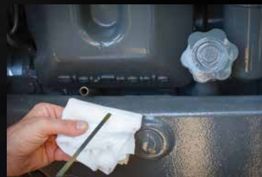
A karcúsított kialakítású motortérburkolat és a mellső híd kialakítása kényelmes hozzáférést biztosít a motorolaj-szűrőkhöz és az olajsínt-ellenőrző pálcához.
