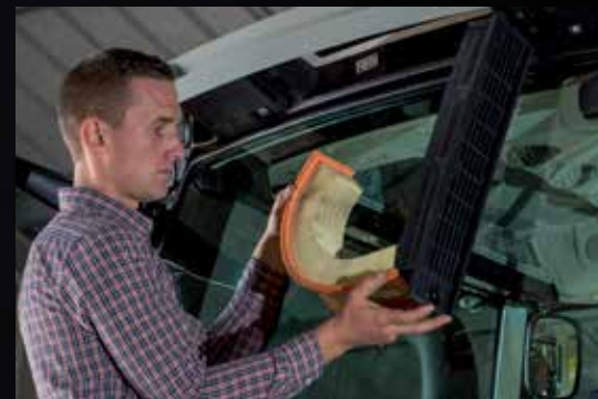
A fülkelégszűrő tisztítás céljából egyszerűen eltávolítható.
