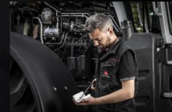
A mellő híd és a „karcsúsított” motorháztető kialakításának köszönhetően az olajsint-ellenőrző nívópálca és a szűrő is könnyen hozzáférhető.
