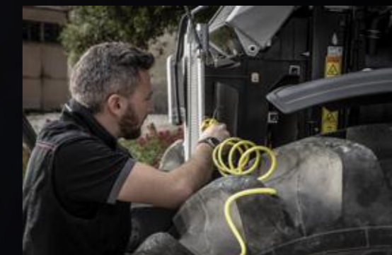
A hűtőegység könnyen hozzáférhető, és ezáltal gyorsabban és egyszerűbben tisztítható.
