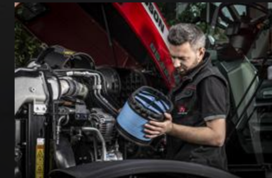
A motor légszűrője könnyen hozzáférhető és tisztítható.
