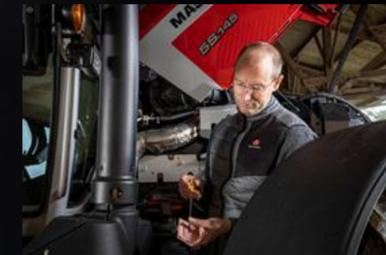
A mellső híd és a „karcsúsított” motorháztető kialakításának köszönhetően a motorolaj nivópálcája és szűrője könnyen hozzáférhető.
