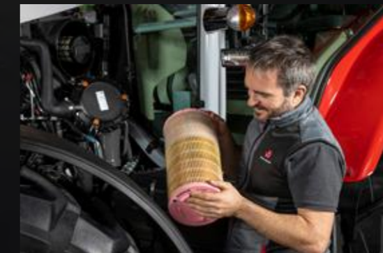
A motor légszűrője könnyen hozzáférhető és tisztítható.
