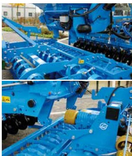
A Heliodor rövidtárcsán (fent) és a Zirkon forgóboronán (lent) lévő univerzális csatlakozás biztosítja azt, hogy a vetőgépet gyorsan át lehet szerelni az egyik talajművelő-eszközről a másikra.
